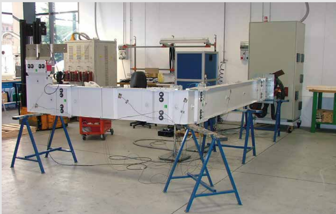
El laboratorio de Legrand durante las pruebas para la certificación de aprobación de los sistemas de electrobarras Zucchini SCP
