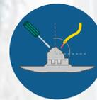
Soporte con bornes inclinados y diseño mejorado para facilitar el cableado y ahorrar tiempo en la instalación.
